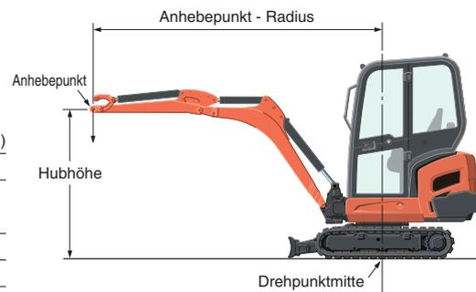
\* Die technischen Daten über den Arbeitsbereich der Maschine wurden mit dem Kubota Original – Tieföffel ermittelt, ohne Schnellwechseleinrichtung.
