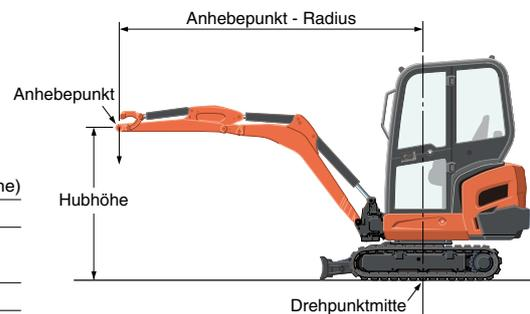
\* Die technischen Daten über den Arbeitsbereich der Maschine wurden mit dem Kubota Standard – Tieföffel ermittelt, ohne Schnellwechseleinrichtung.
