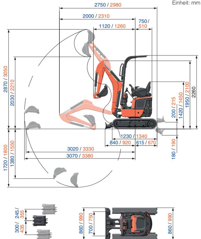
\* Die technischen Daten über den Arbeitsbereich der Maschine wurden mit dem Kubota original - Tieföffel ermittelt, ohne Schnellwechseleinrichtung.
